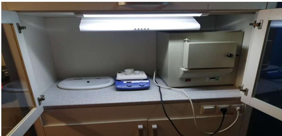
Расми 1. Электроплитка ва печи муфелӣ барои ҳокистаркунонии намунаҳои маводи ғизоӣ
